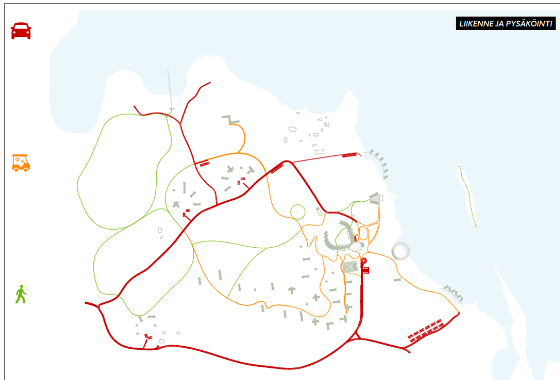
Kuva 27: Liikenteen ja pysäköinnin periaate, punaisella kadut, oranssilla huolto- reitit ja vihreällä jalankulku (e & j arkkitehdit).
